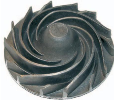
c) Fertiges Bauteil aus Stahl X210CrW12.
