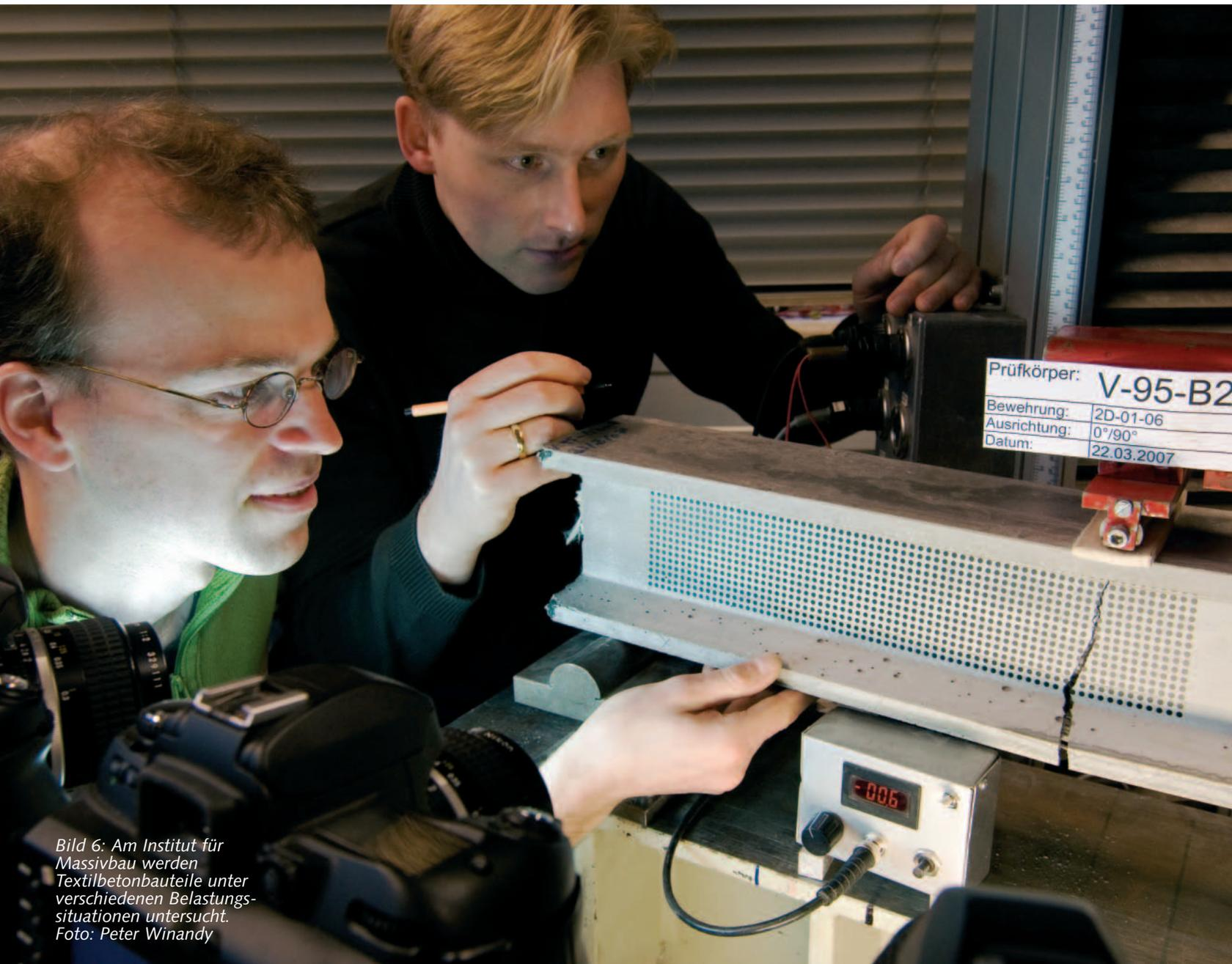
Bild 6: Am Institut für Massivbau werden Textilbetonbauteile unter verschiedenen Belastungssituationen untersucht.
