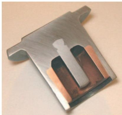
Bild 3: Musterteile Thixojoining: Durch Thixoforming hergestelltes Verbundbauteil aus Stahl X210CrW12 mit Einlegeteilen aus einer Kupferlegierung CuCoBe (Gleitbuchse) und einem Stahl X5CrNi18-10 (Stift).
